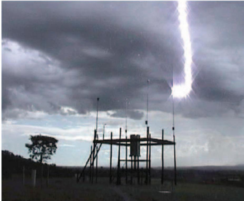
Figura 3.4: Descarga através do lançamento de um foguete [10]
