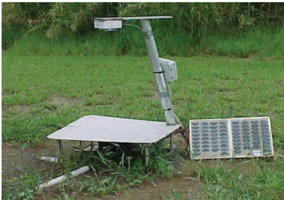
Figura 3.2: Medidor de campo elétrico usado em Cachoeira Paulista [10]
