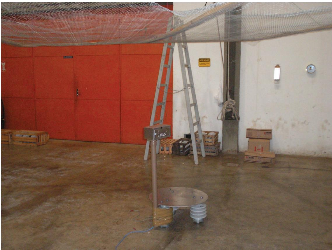
Figura 6.6: Montagem referente ao segundo teste do sensor EFM
