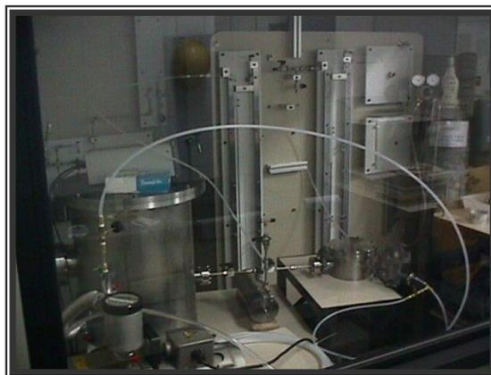
**Figura F.5** Arranjo experimental utilizado para medir a descarga de gases em bocais.
