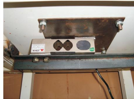
Fig. 3.4: Célula de carga fixada na estrutura da plataforma.
