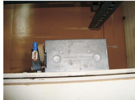
Fig. 3.2: Fechadura mecânica usada para disparar o sistema de alçapão.
