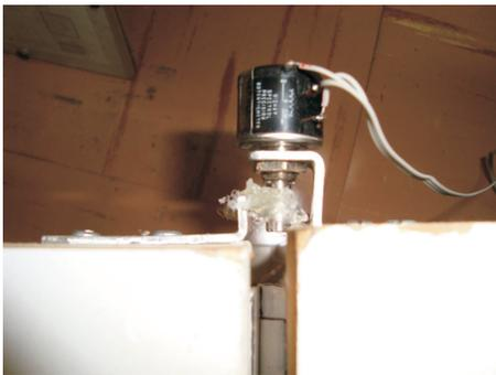
Fig. 3.3: Potenciômetro de precisão acoplado ao eixo da plataforma.
