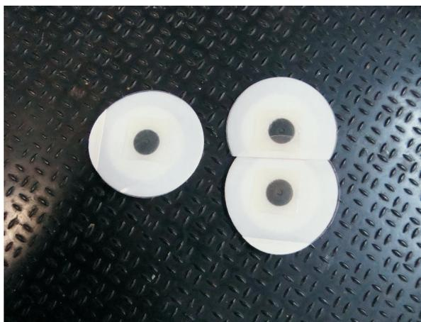
Fig. 4.3: Eletrodos utilizados para os testes.
