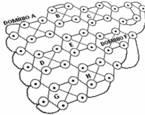
**Figura 1.8** – Exemplo de hierarquização utilizando uma rede em malha de 6 nós.
