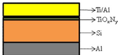
(c) Capacitores MOS com estrutura  $Ti/Al/TiAlO_xN_y/Si$
