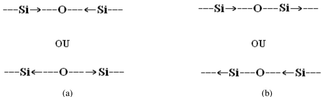
Figura D.2: (a) estiramento simétrico e (b) estiramento assimétrico
