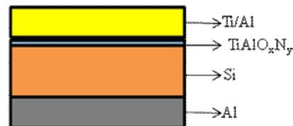
Figura 2. 2: (a) Etapas de fabricação das estruturas MOS pertencentes aos grupos III e VI, (b) Esquema em corte de um capacitor MOS do grupo III e (c) Esquema em corte de um capacitor do grupo VI.
