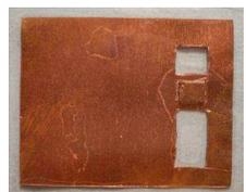
O simulador de uniformidade, ilustrado na Tabela 1 e visto ao lado, é constituído basicamente por uma única lâmina de cobre com área de 50 x 40 mm e espessura de 0,1 mm. Este simulador também é posicionado diretamente sobre o detector de radiação e está associado à medida do ruído, ou seja, à estimativa da densidade espectral de ruído (*NPS*). Como ilustrado na figura à esquerda, este simulador conta com uma região uniforme (região **A**) e dois marcadores (regiões **B** e **C**):
