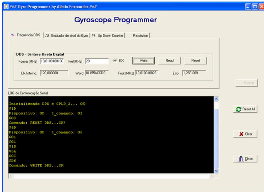
Fig. 4-29: Módulos de ajuste do sinal do emulador do giroscópio.
