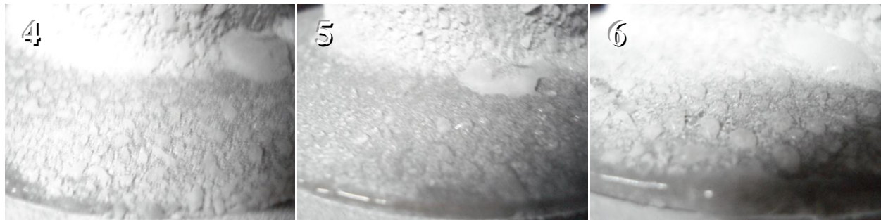
Figura 3.19 - Imagens da hidrofobicidade transferida para superfícies artificialmente poluídas por deposição de camada sólida por 96 horas dos para-raios das amostras 4 a 6 do fabricante A.
