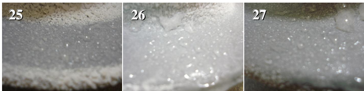
Figura 3.22 - Imagens da hidrofobicidade transferida para superfícies artificialmente poluídas por deposição de camada sólida por 96 horas dos para-raios das amostras 25 a 27 do fabricante D.
