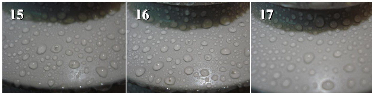
Figura 3.18 - Imagens da hidrofobicidade recuperada em 48 horas após perda das superfícies imersas em água deionizada por 96 horas dos para-raios das amostras 15 a 17 do fabricante E.
