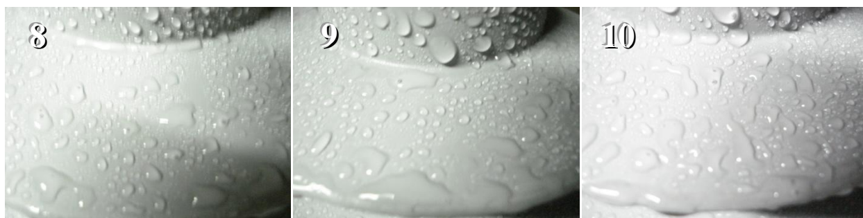
Figura 3.10 - Imagens da hidrofobicidade perdida das superfícies imersas em água deionizada por 96 horas dos para-raios das amostras 8 a 10 do fabricante C.
