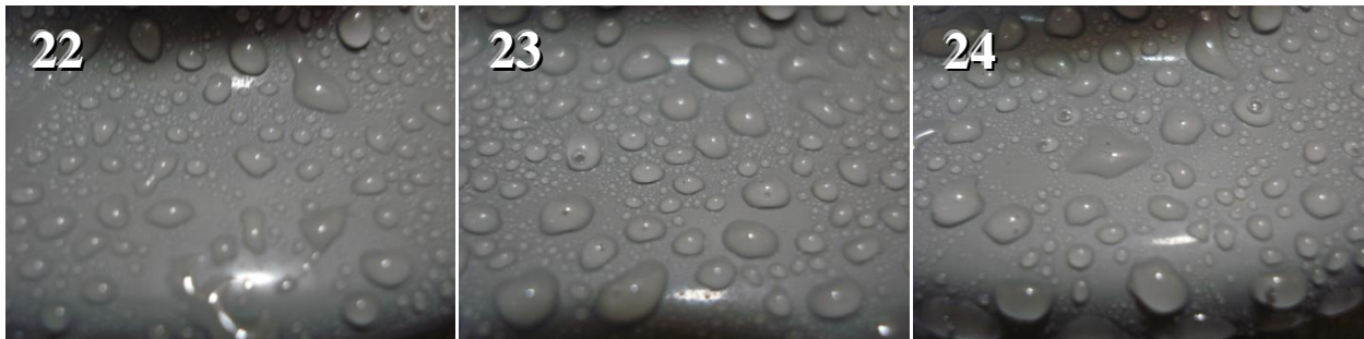
Figura 3.17 - Imagens da hidrofobicidade recuperada em 48 horas após perda das superfícies imersas em água deionizada por 96 horas dos para-raios das amostras 22 a 24 do fabricante D.
