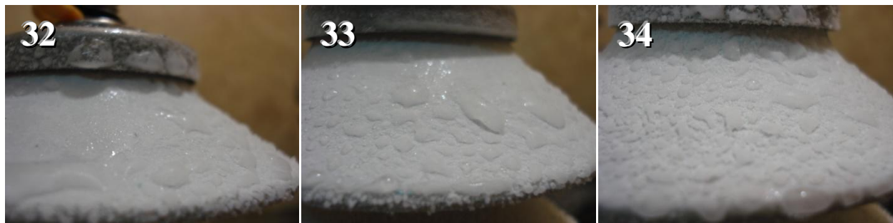
Figura 3.20 - Imagens da hidrofobicidade transferida para superfícies artificialmente poluídas por deposição de camada sólida por 96 horas dos para-raios das amostras 32 a 34 do fabricante B.
