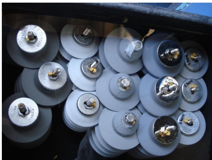
Figura 3.7 - Para-raios imersos em água deionizada por período de 96 horas.
