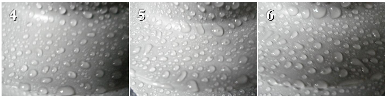
Figura 3.24 - Imagens da hidrofobicidade recuperada em 48 horas após limpeza superfícies artificialmente poluídas por deposição de camada sólida por 96 horas dos para-raios das amostras 4 a 6 do fabricante A.
