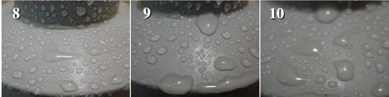
Figura 3.16 - Imagens da hidrofobicidade recuperada em 48 horas após perda das superfícies imersas em água deionizada por 96 horas dos para-raios das amostras 8 a 10 do fabricante C.
