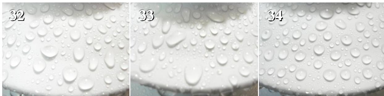
Figura 3.25 - Imagens da hidrofobicidade recuperada em 48 horas após limpeza superfícies artificialmente poluídas por deposição de camada sólida por 96 horas dos para-raios das amostras 32 a 34 do fabricante B.
