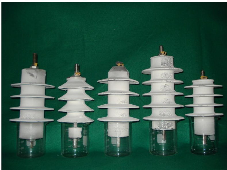
Figura 3.13 - Camada de deposição de poluição artificial nas superfícies dos para-raios.
