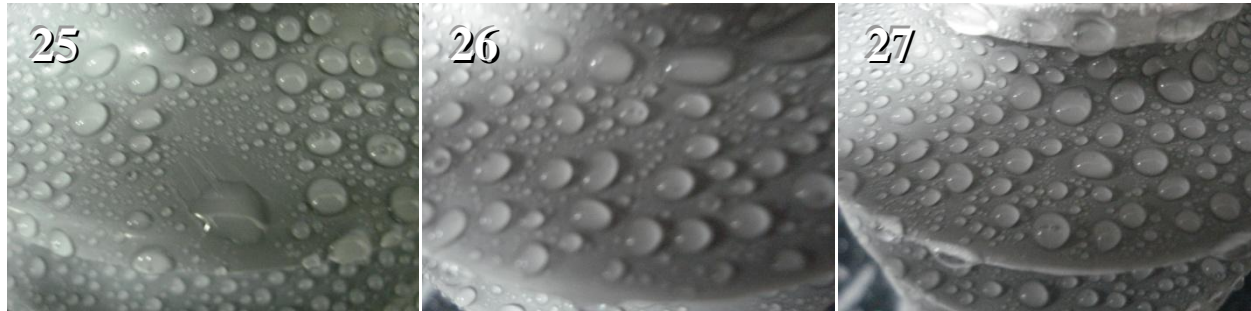
Figura 3.27 - Imagens da hidrofobicidade recuperada em 48 horas após limpeza superfícies artificialmente poluídas por deposição de camada sólida por 96 horas dos para-raios das amostras 25 a 27 do fabricante D.
