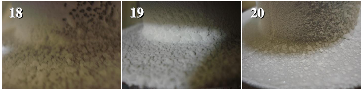
Figura 3.23 - Imagens da hidrofobicidade transferida para superfícies artificialmente poluídas por deposição de camada sólida por 96 horas dos para-raios das amostras 18 a 20 do fabricante E.
