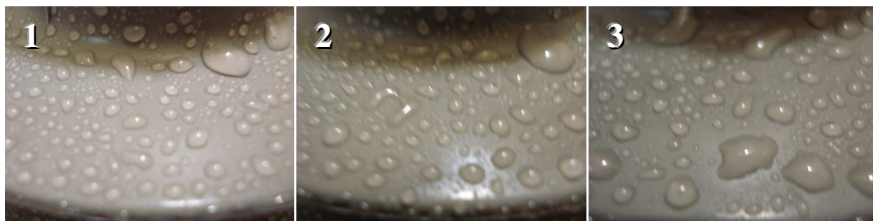
Figura 3.14 - Imagens da hidrofobicidade recuperada em 48 horas após perda das superfícies imersas em água deionizada por 96 horas dos para-raios das amostras 1 a 3 do fabricante A.
