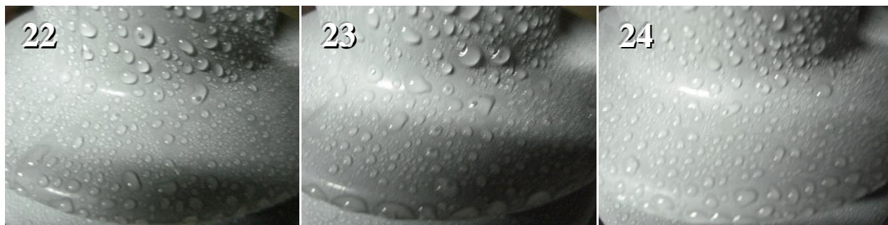
Figura 3.11 - Imagens da hidrofobicidade perdida das superfícies imersas em água deionizada por 96 horas dos para-raios das amostras 22 a 24 do fabricante D.
