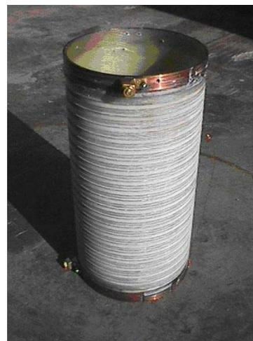
Fig. 9.5 (a) – Conjunto de bobinas do limitador de corrente tipo W – Fita AMS.
