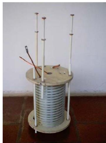
Fig. 9.6 – Flanges, tirantes e conjunto limitador de corrente tipo W montado.
