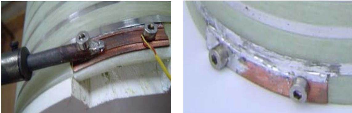
Fig. 9.2 – Processo de soldagem da fita supercondutora nas juntas e terminais de cobre.
