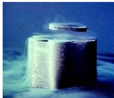
Fig. 2.3 – Efeito Meissner: Levitação de ímã permanente sobre um material supercondutor - expulsão de linhas de campo magnético. Fonte: [www.superconductor.org](http://www.superconductor.org)
