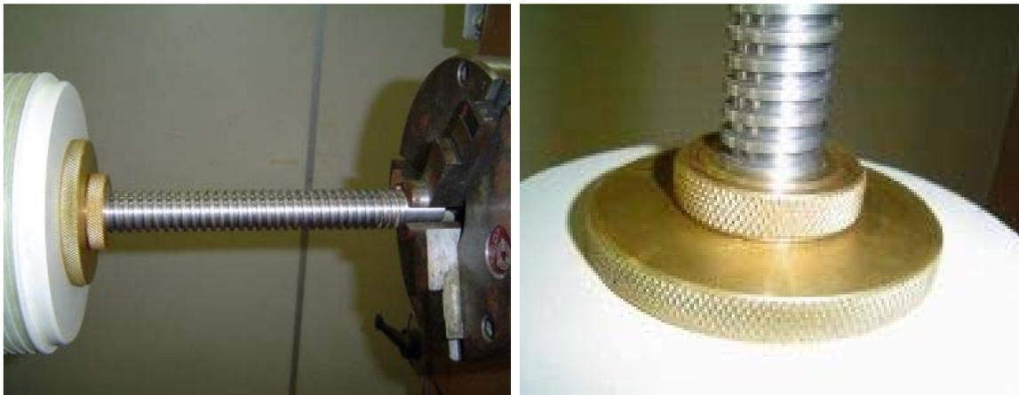
Fig. 9.3 – Eixo usinado em rosca e arruela de fixação para movimentação axial da bobina a ser enrolada.
