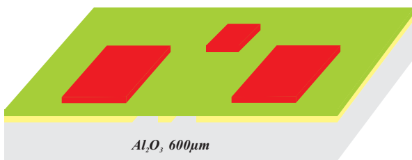
(e) Máscara 2 - Definição do dielétrico
