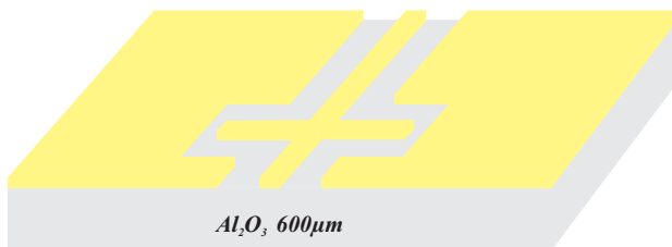
(c) Corrosão e abertura das linhas CPW
