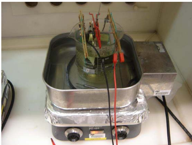
Figura C.12: Foto do arranjo de Deposição Eletrolítica
