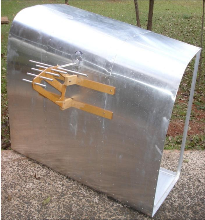
(a) Protótipo construído com pedaços de madeira para suportar os diretores.
