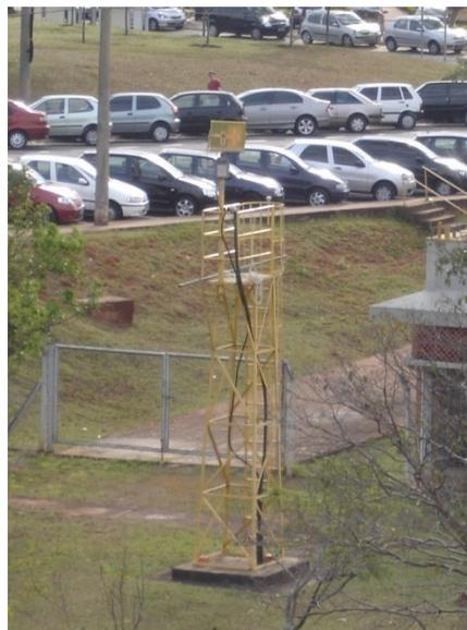
(c) Antena QY em teste no alto da torre de recepção.
