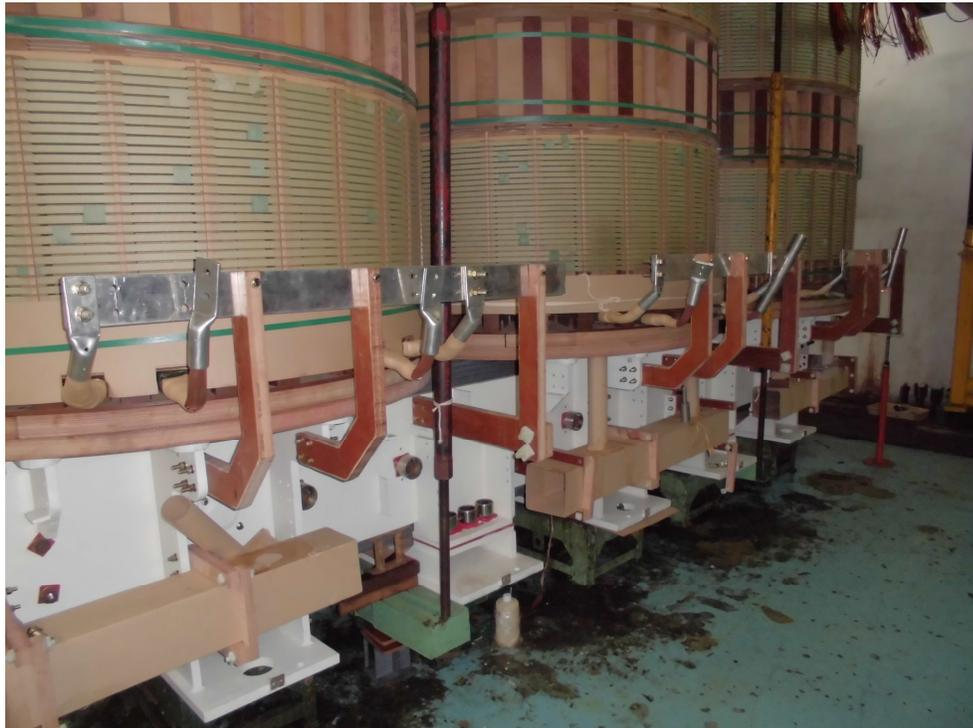
Figura 16 – Isolamento Entre Espiras de um Transformador Novo
