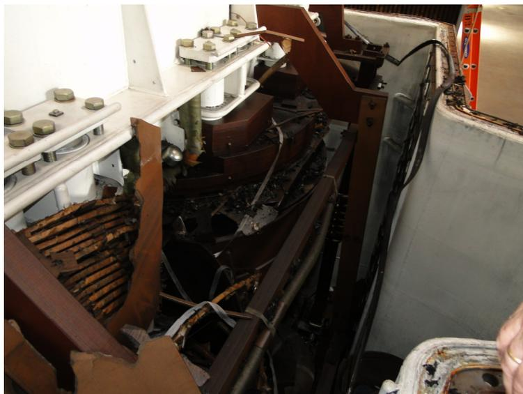
Figura 1 – Vista do Interior de um Transformador Avariado
