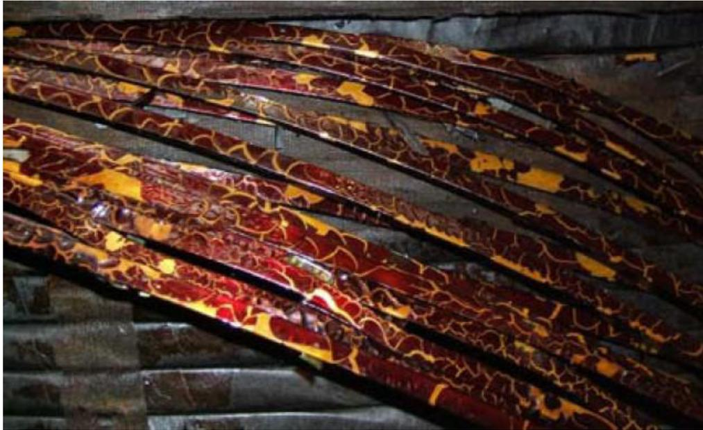
Figura 15 – Enrolamento de Transformador com Papel Isolante de GP < 200<sup>47</sup>
