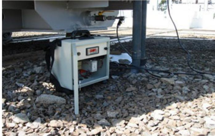
Figura 27 – Coleta de dados “on line” de temperatura do óleo e saturação relativa da água no óleo MO
