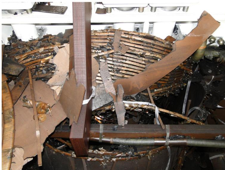
Figura 2 – Detalhe Danos Internos no Transformador Após a Falha
