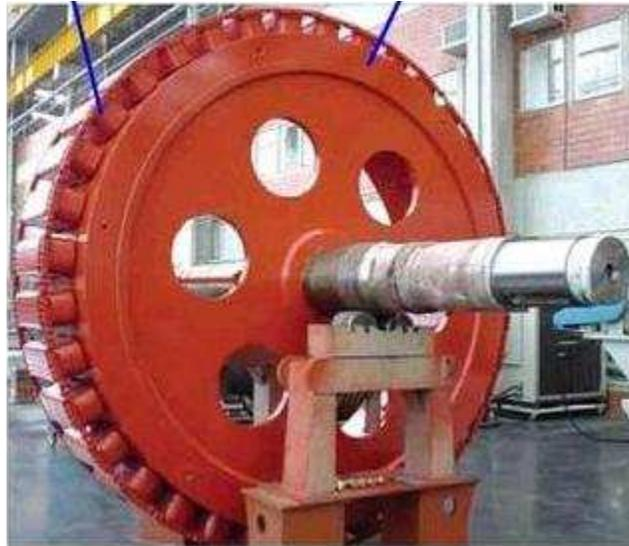
Figura 2.5 – Rotor de pólos salientes
