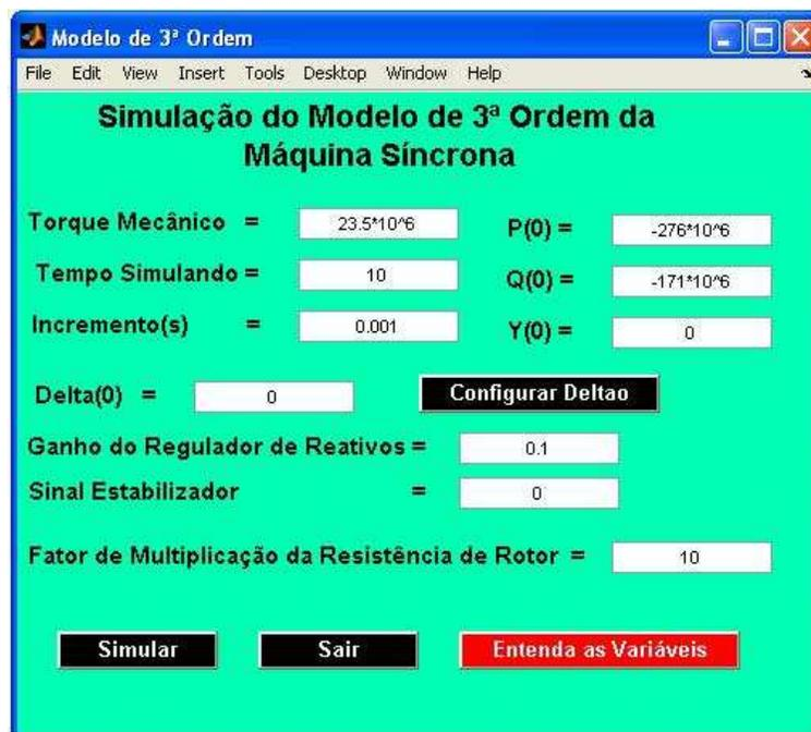
Figura 6.1 – Simulação do modelo de 3ª ordem conforme Tabela 6.2.
