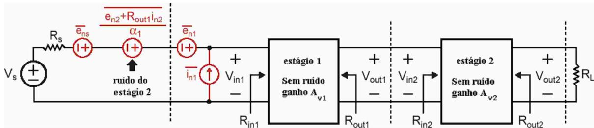
Figura A-10 : Sistemas quatro terminais com ruído total equivalente na entrada.
