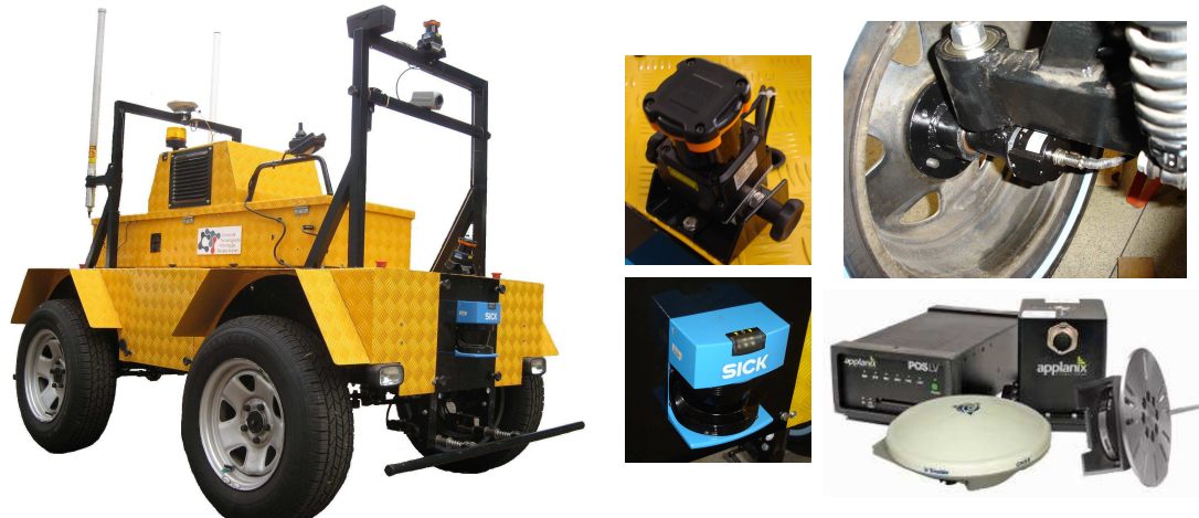
Figura 1.1: O veículo robótico do projeto VERO e sensores embarcados – um dos encoders incrementais das rodas (na figura superior direita), dois lasers que são posicionados na parte frontal do veículo (imagens ao centro), assim como o sistema de posicionamento Applanix, que fornece informações de pose com precisão centimétrica e é utilizado como referência (imagem inferior direita).
