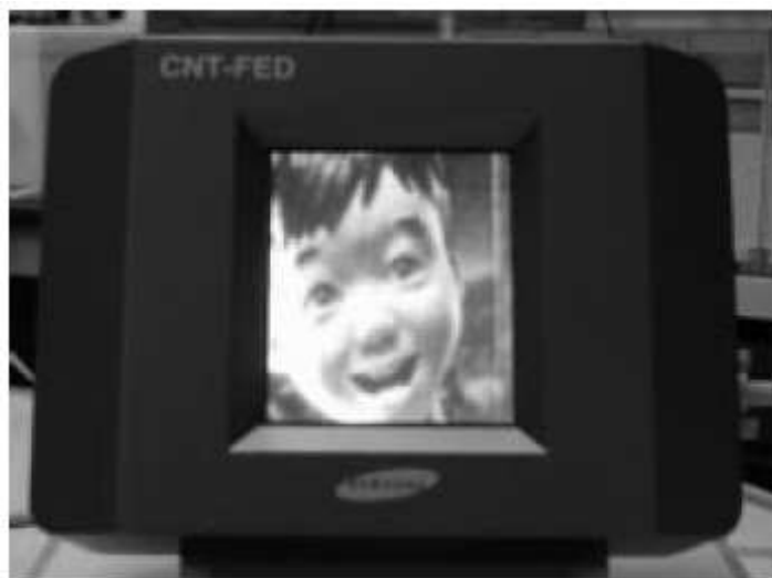
Figura II-9. Imagem de um filme em um FED de nanotubos de carbono de 5 pol. (Samsung Advanced Institute of Technology) [19].
