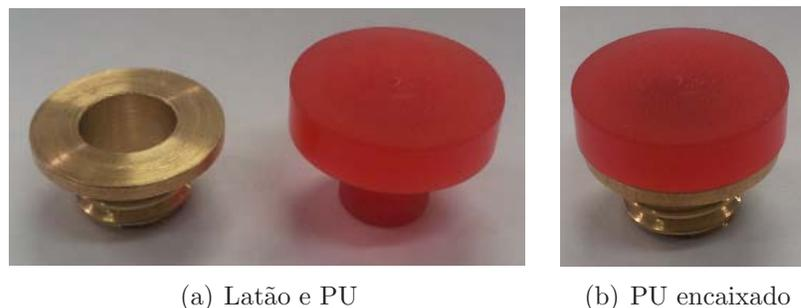
Figura 3.6: Detalhe da peça de interface entre o vidro temperado e as vigas da PF.
