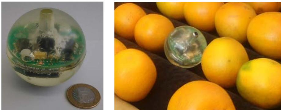
Figura 2.6: EESF com encapsulamento de PU e ao lado de laranjas.
