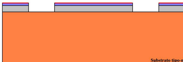
Figura C7 – 4ª Etapa do processo de fabricação do sensor no CCS/Unicamp: Corrosão do óxido do 1º nível de máscara.
