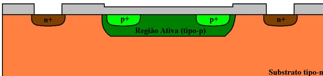
Figura C18 – 15ª Etapa do processo de fabricação do sensor no CCS/Unicamp: Implantação do anel de guarda (região n+) dos piezoelementos.
