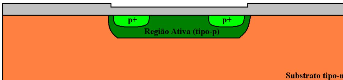
Figura C14 – 11ª Etapa do processo de fabricação do sensor no CCS/Unicamp: Ativação dos dopantes e oxidação úmida.
