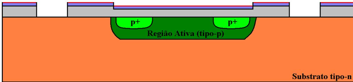
Figura C16 – 13ª Etapa do processo de fabricação do sensor no CCS/Unicamp: Corrosão do óxido do 3º nível de máscara.
