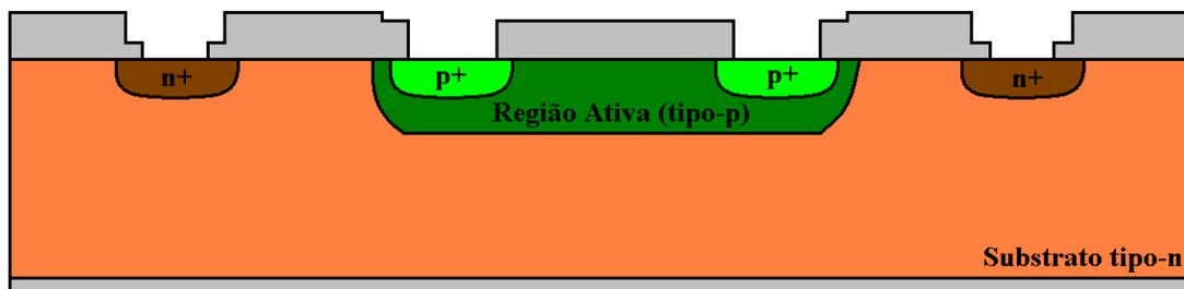
Figura C22 – 19ª Etapa do processo de fabricação do sensor no CCS/Unicamp: Remoção do fotorresiste do 4º nível de máscara.
