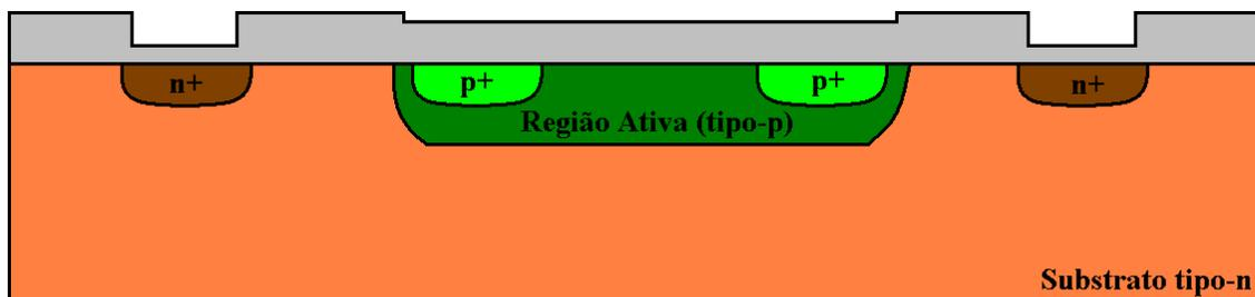
Figura C19 – 16ª Etapa do processo de fabricação do sensor no CCS/Unicamp: Ativação dos dopantes e oxidação seca.
