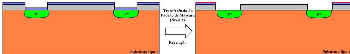
Figura C10 – 7ª Etapa do processo de fabricação do sensor no CCS/Unicamp: Fotograbagem do 2º nível de máscara (região ativa dos piezoelementos).
