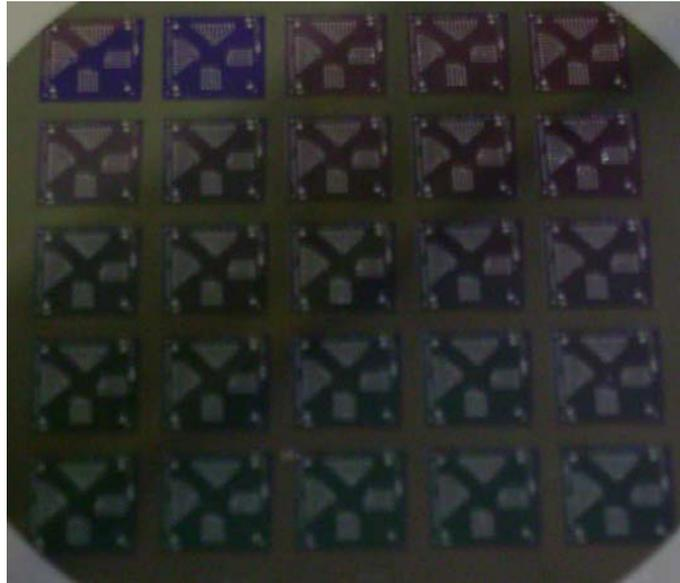
Figura 7.15 – Lâmina com 25 *chips* fabricados no CCS/Unicamp.
