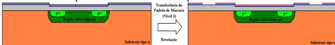
Figura C15 – 12ª Etapa do processo de fabricação do sensor no CCS/Unicamp: Fotogravação do 3º nível de máscara.
