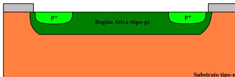
Figura C13 – 10ª Etapa do processo de fabricação do sensor no CCS/Unicamp: Implantação da região ativa dos piezoelementos (região p).
