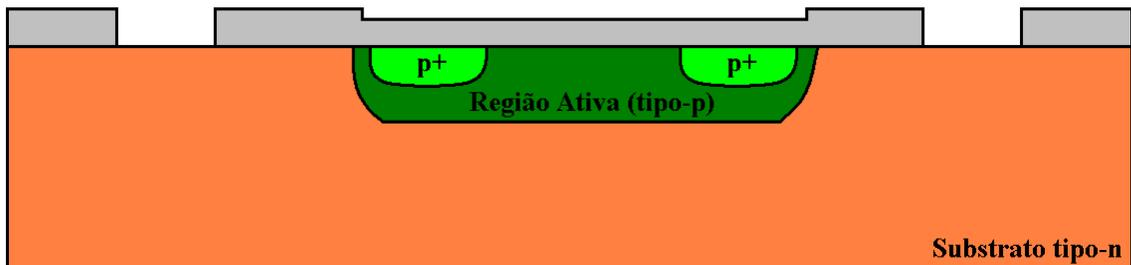
Figura C17 – 14ª Etapa do processo de fabricação do sensor no CCS/Unicamp: Remoção do fotorresiste do 3º nível de máscara.
