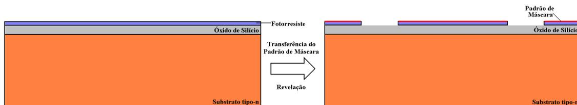
Figura C6 – 3ª Etapa do processo de fabricação do sensor no CCS/Unicamp: Fotogravação do 1º nível de máscara (região de contatos p+ dos piezoelementos).
