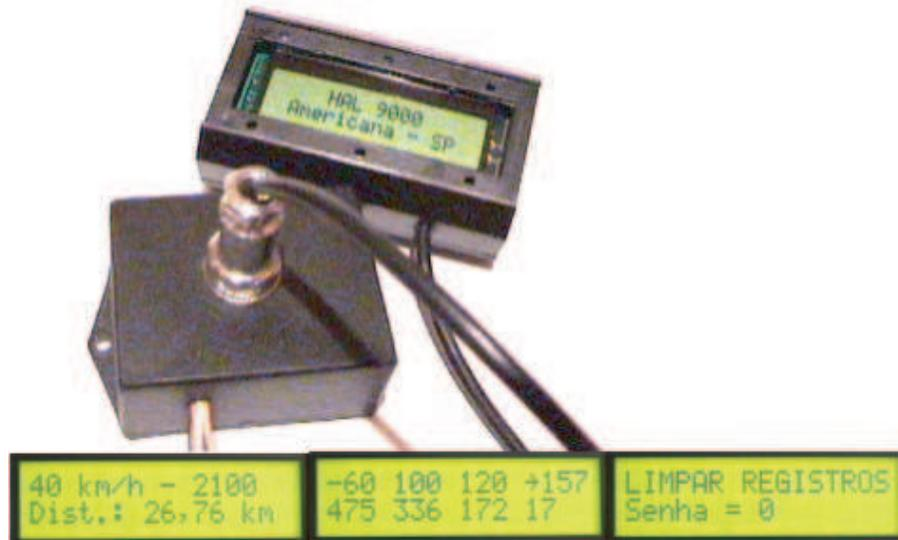
Fig. 4.1: Primeiro protótipo de computador de bordo
