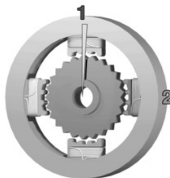
Figura 2.11 – Segundo solenóide é energizado e o primeiro é desativado.
