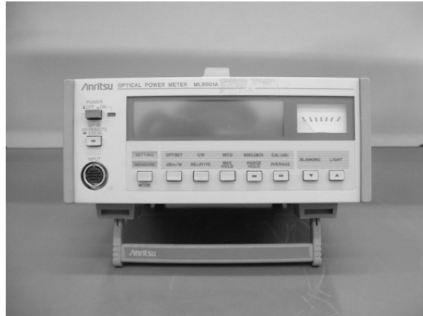
Figura 2.8 – Medidor de potência óptico.
