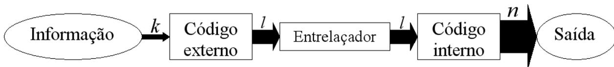
Fig. 3.2: Sistema de Concatenação Serial
