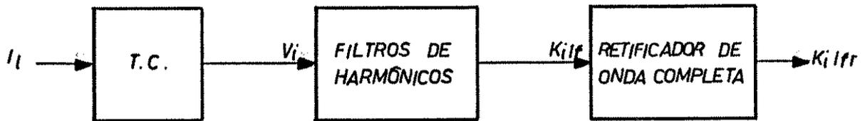
**FIG.2.12.** ESQUEMA DE BLOCOS PARA A AMOSTRA DE CORRENTE
