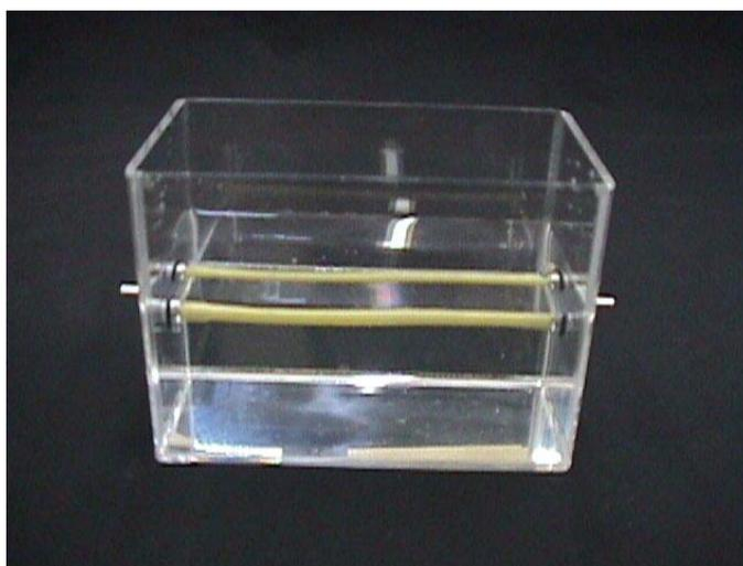
*Figura 12: Caixa de acrílico em que foi preparado o tecido, o tubo atravessa a caixa de um lado ao outro conectado pelas peças de alumínio. Embora pareça haver 2 tubos, o segundo tubo é reflexão.*
