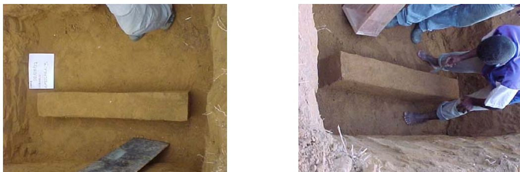
Figura 3.2. 3 - Amostras de solo com dimensões apropriadas
