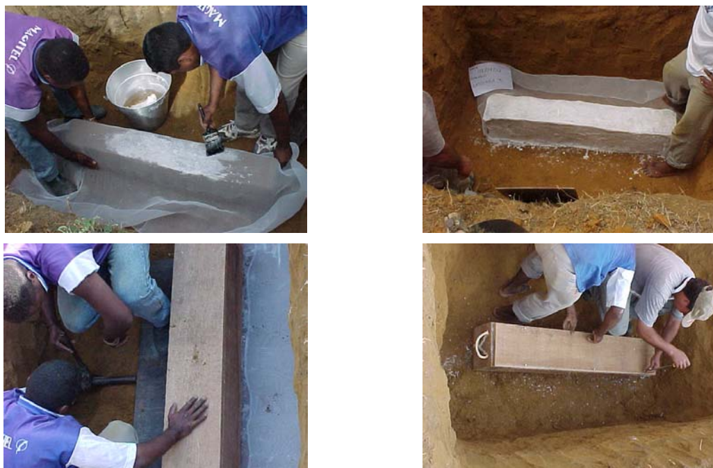
Figura 3.2. 4 – Amostras de solo sendo recobertas com camada de parafina líquida.
