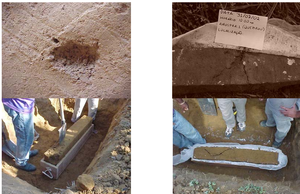
Figura 3.2. 2 – Amostras de solo com estrutura física comprometida
