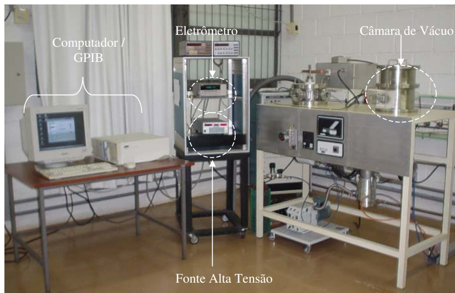
Fig.38 – Sistema de medidas para caracterização elétrica das pontei­ras.
