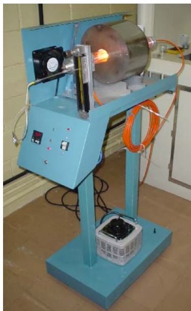
fig.31.Forno de oxidação com sistema de controle de temperatura (microcontrolador).
