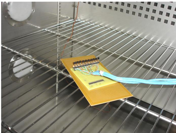
Fig. 5.4 – Placa contendo os dez sensores de temperatura dentro da câmara climática.
