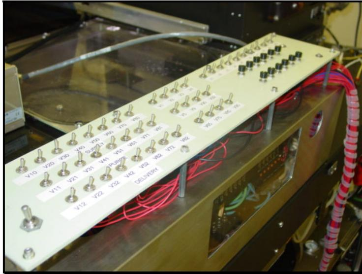
Figura 68 – Controlador manual de válvulas pneumáticas
