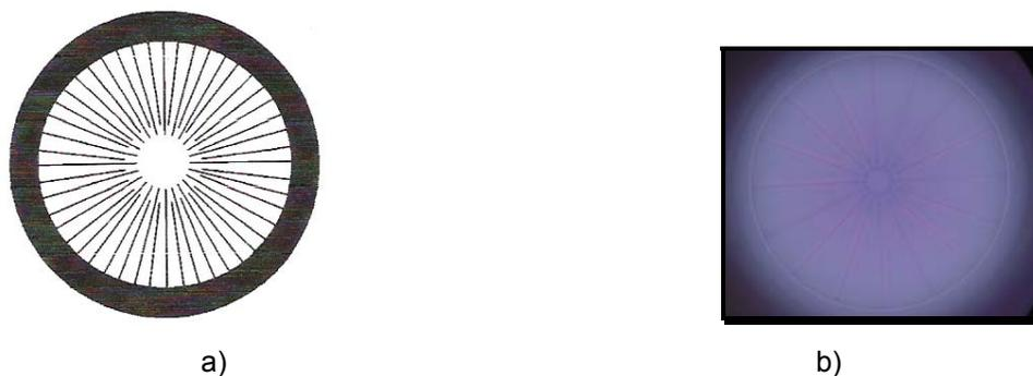
Figura 34 – a)Exemplo de uma configuração de blindagem de Faraday. b) Vista frontal da câmara onde aparece o plasma gerado e as tiras de cobre utilizadas para a formação da blindagem de Faraday utilizada.
