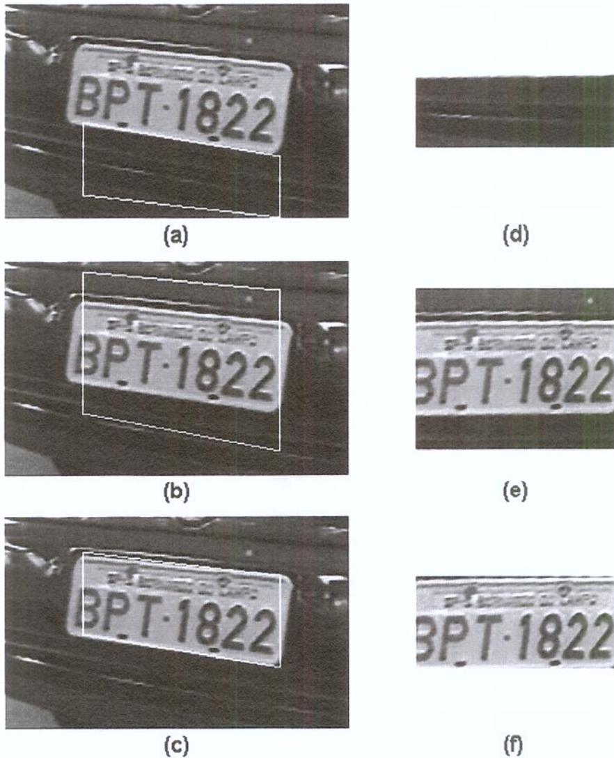
**Fig. 4.39:** Correção da distorção de perspectiva: (a) arestas do quadrilátero 1; (b) arestas do quadrilátero 16; (c) arestas do quadrilátero 22; (d) imagem corrigida do quadrilátero 1; (e) imagem corrigida do quadrilátero 16 e (f) imagem corrigida do quadrilátero 22.
