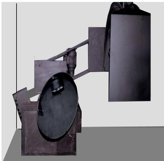
**Figura: VI.10 - Detalhe do espelho e do braço pantográfico inclinado.**
