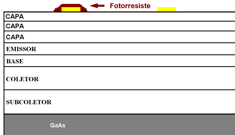
FIGURA 4.7 – FOTOLITOGRAFIA PARA DEFINIÇÃO DA MESA DE EMISSOR
