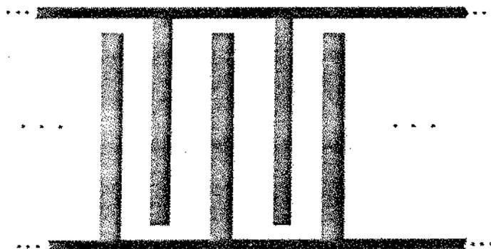
Figura (III.3-1) - Configuração do filtro interdigital
