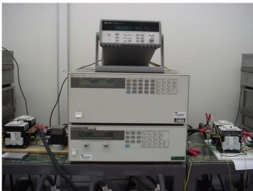
**Figura 5.3 - Equipamentos de Carga e Descarga dos Elementos**
