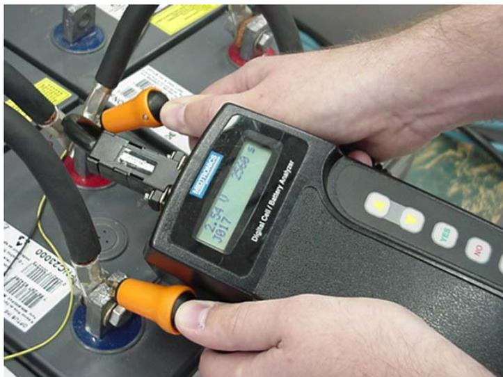
**Figura 5.4 - Equipamento de Condutância**
