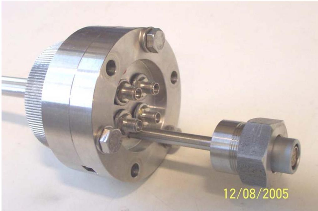
Fig. 5.9: Detalhe das flanges com o conector SMA
