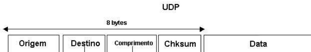
Fig.2.3 Estrutura do protocolo UDP.
