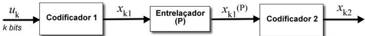
Fig.9.10 Diagrama de codificador turbo serial
