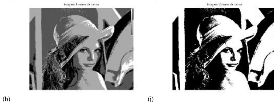
Figura 2.4 Efeito da diminuição de níveis de cinza de uma imagem.
