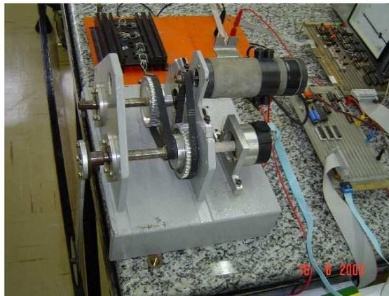
Figura 1.3: Bancada experimental com a montagem do pêndulo acionado.
