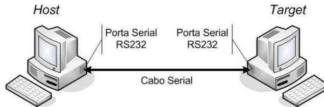
Figura 2.7: Esquema de comunicação entre os computadores *host* e *target* via porta serial.
