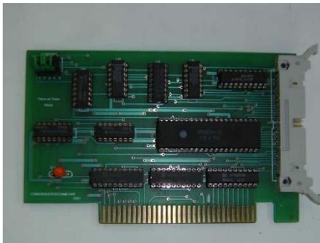
Figura 4.18: Placa de aquisição *ISA*.
