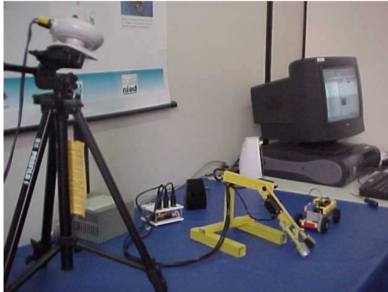
Figura 6.65 Instalação física do ambiente de telerobótica
