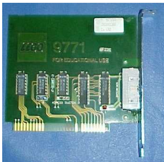
Figura 2.8 Placa da interface Lego 70288
