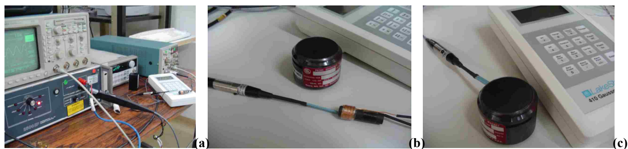
Fig. 23. Sistema de Calibração (a) Equipamentos (b) Medição do campo gerado pela caneta (c) Calibração do gaussímetro
