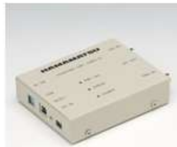
Figura 3.9 – Foto e desenhos das vistas superior e laterais da placa de contagem de pulsos C8855, mostrando seus conectores e LEDs indicadores, adaptado de [63].
