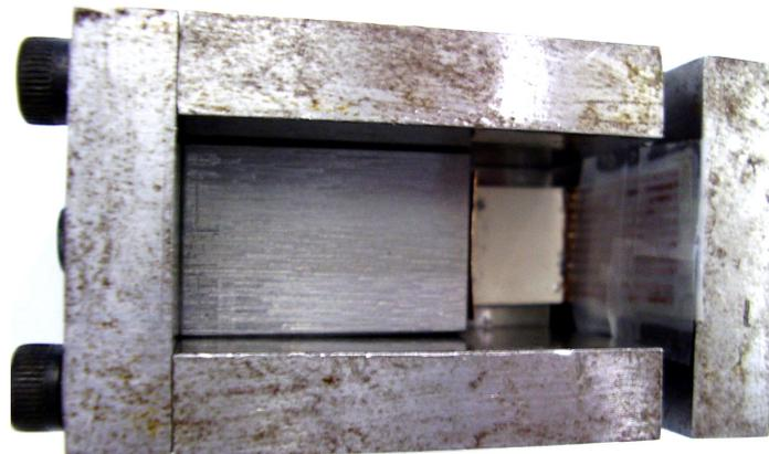
Figura 3.17: Posição da cerâmica dentro do molde, antes da colocação da camada de retaguarda.
