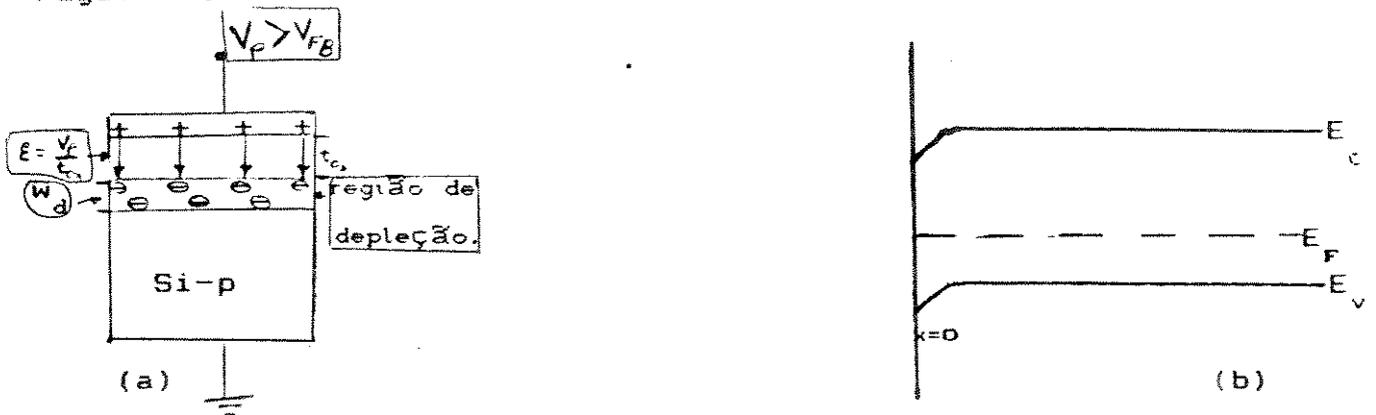
Fig.5.4 - (a) Esquematização da região de depleção no capacitor; (b) Diagrama de bandas do silício, com o encurvamento dos níveis  $E_c$  e  $E_v$ .
