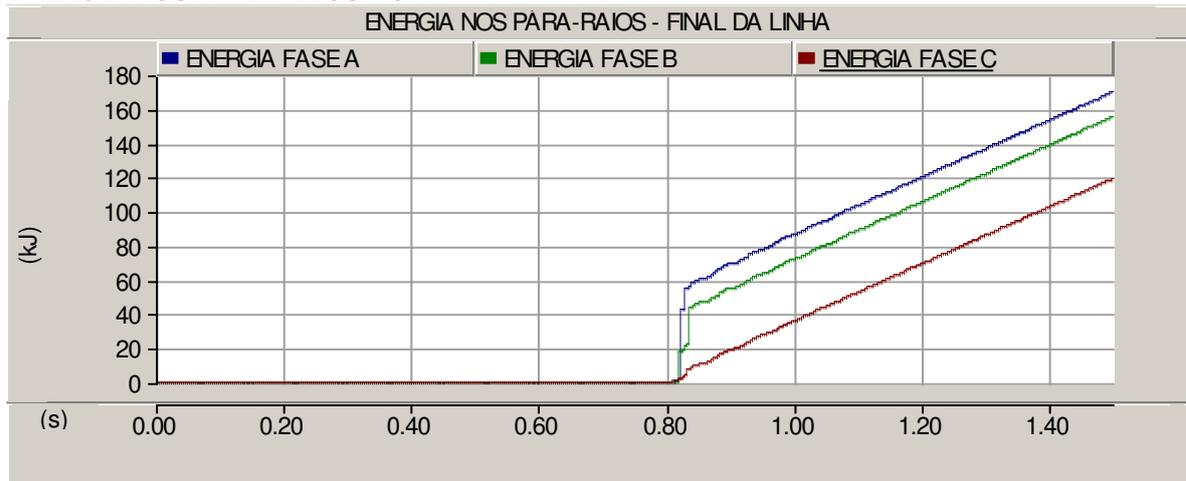
**Figura 29.** Energia dissipada nos pára-raios. Manobra de energização utilizando pára-raios 420 kV nos terminais e no meio da linha - 75 % de compensação reativa em derivação.
