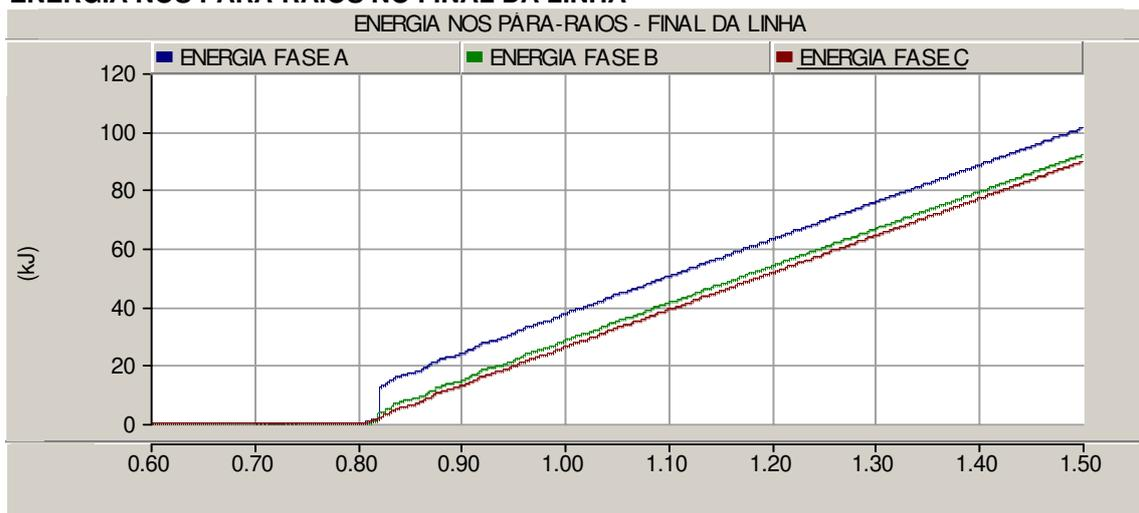
**Figura 20.** Energia dissipada nos pára-raios.- Manobra de energização utilizando pára-raios 420 kV nos terminais e no meio da linha – LT com 91 % de compensação reativa em derivação
