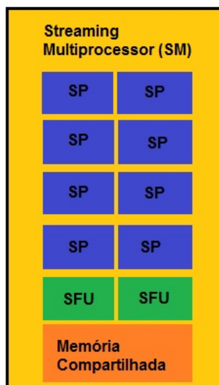
Figura 3.2: Organização simplificada de um SM (Kirk and Hwu, 2010).
