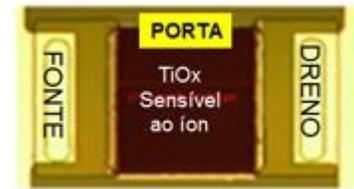
Figura 4-28 – A) Arranjos de 78 ISFETs com filme de TiOx como elemento sensor ao íon H<sup>+</sup> - amostra ISFET SP\_20\_960\_I e B) Detalhe de um transistor ISFET (50x50µm) com filme de TiOx como elemento sensor ao íon H<sup>+</sup>.
