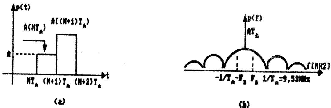
Fig. III.41 - Sinal na saída do D/A
