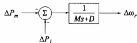
Figura 24 - Diagrama de blocos referente a variação de potência elétrica.
