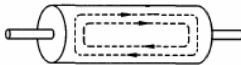
Figura 16 - Ilustração gráfica das correntes de fuga.
