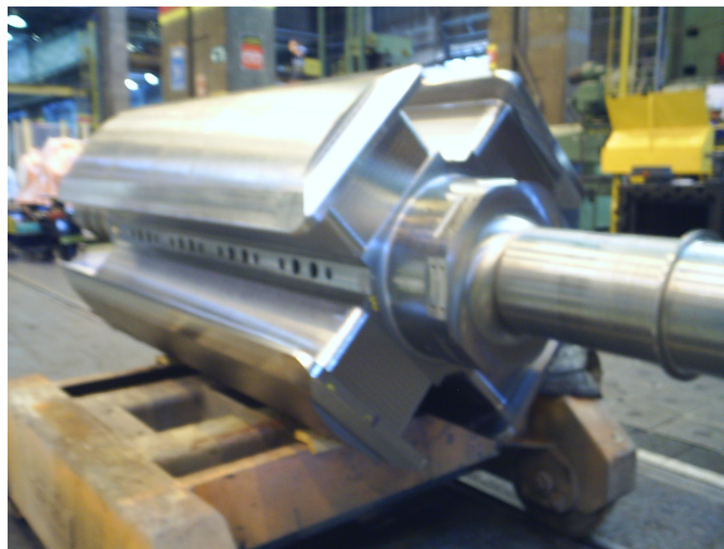
Figura 17 - Exemplo de um rotor de quatro pólos.
