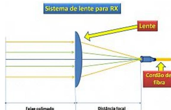
Fig. 4.30 – Esquema de colimação do sinal para RX
