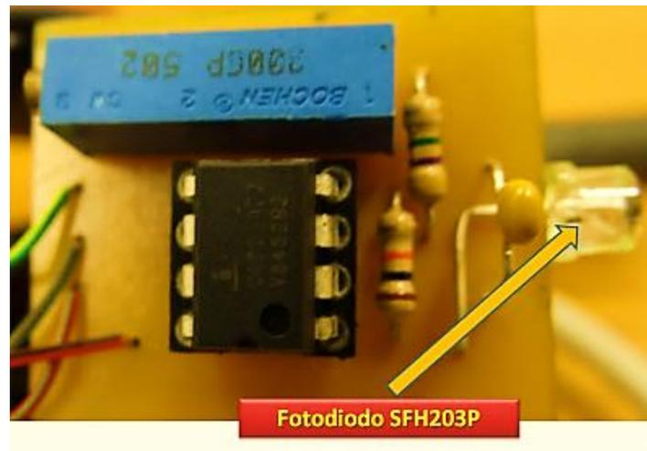
Fig. 4.5 – Circuito conversor óptico-elétrico
