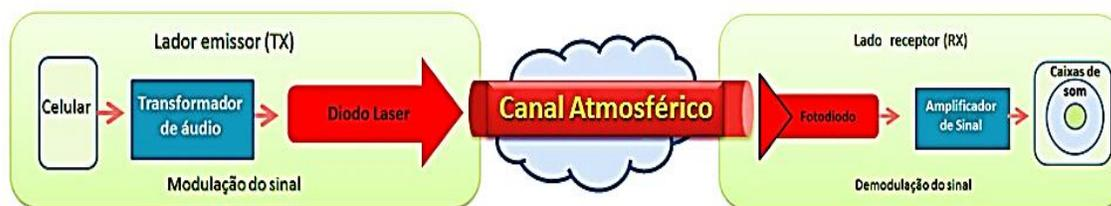
Fig. 4.1 – Esquemático do setup experimental para o link de áudio
