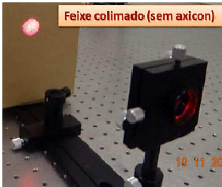
Fig. 4.44 – Sinal do laser colimado após passar pelo filtro espacial.
