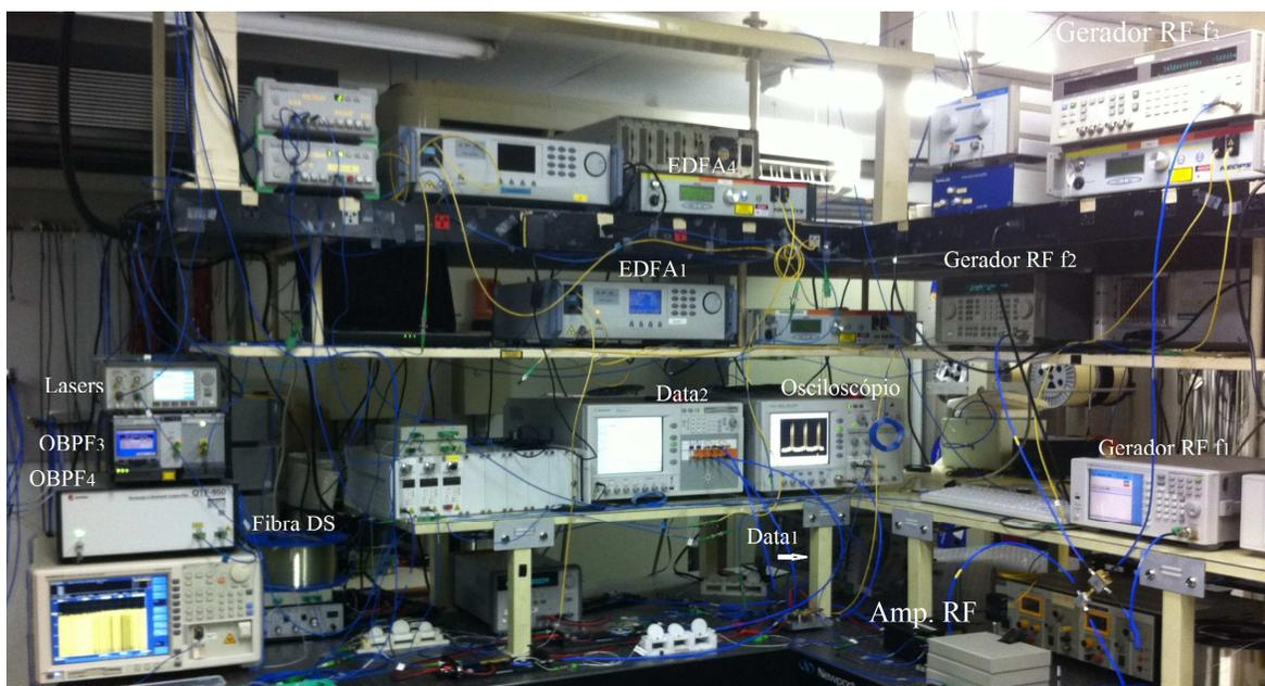
**Figura 5.8** - Foto dos lasers, amplificadores, geradores de RF, amplificador de RF, geradores de dados, a fibra DS e os filtros do sinal conjugado.
