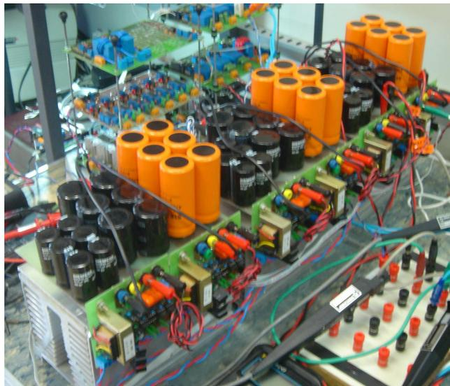
**Figura D. 21** – Inversor Multinível em Aascata trifásico com 3 células monofásicas por fase
