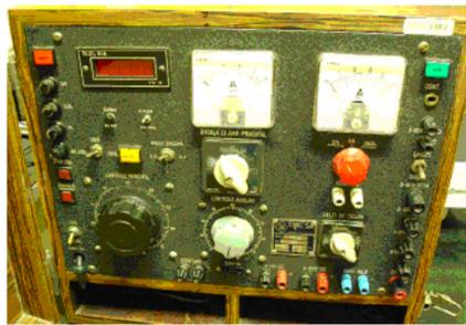
Fig. 5 – Caixa de Testes de Relés Eletro-Eletrônico
