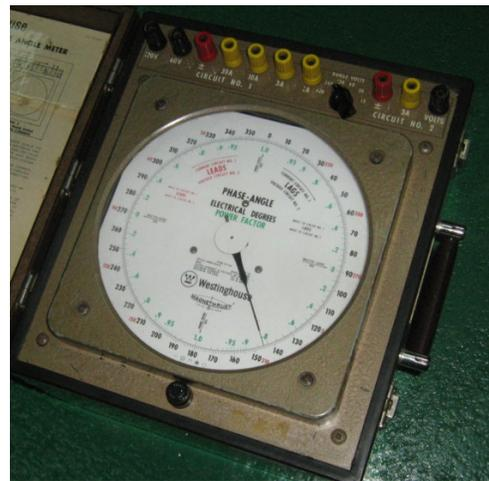
Figura 3.1.b - Medidor de ângulo
