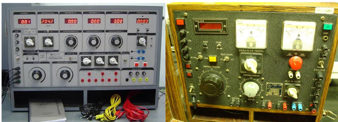
Figura 3.4 – Caixa de testes para relés eletromecânicos e estáticos
