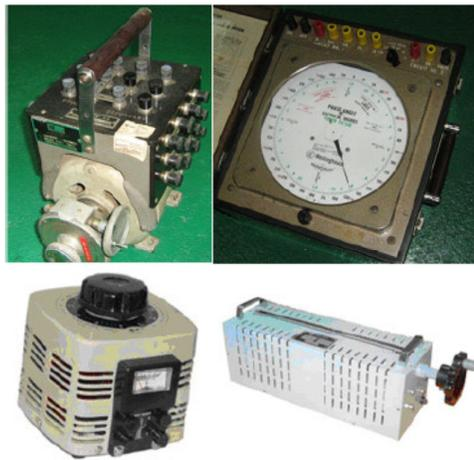
Fig. 1 – Defasador, Medidor de Ângulo, Variac e Reostato
