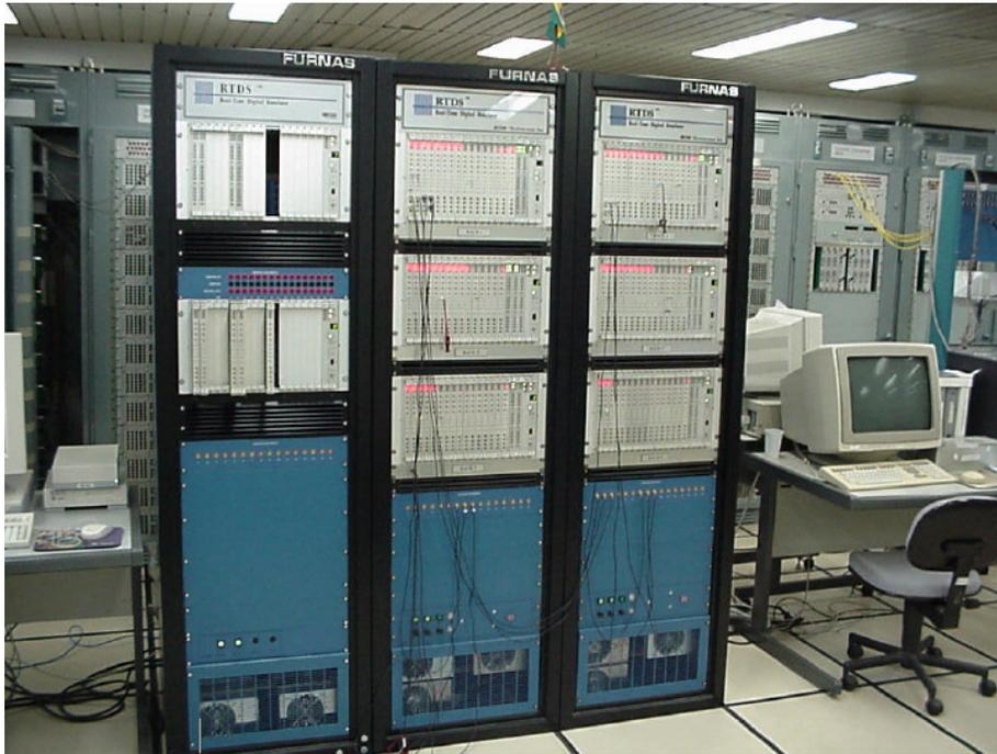
Figura 4.4 – Simulador digital em tempo real (RTDS)
