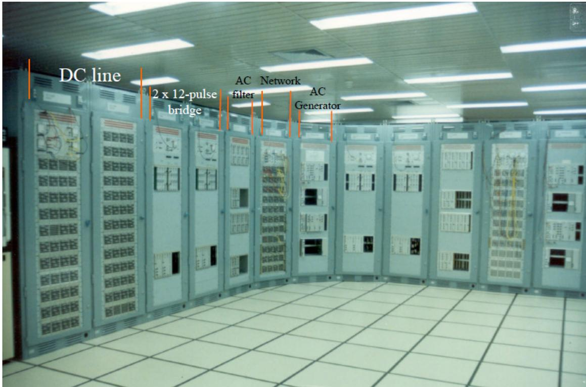
Figura 4.3 - Simulador analógico de tempo real (RTAS)
